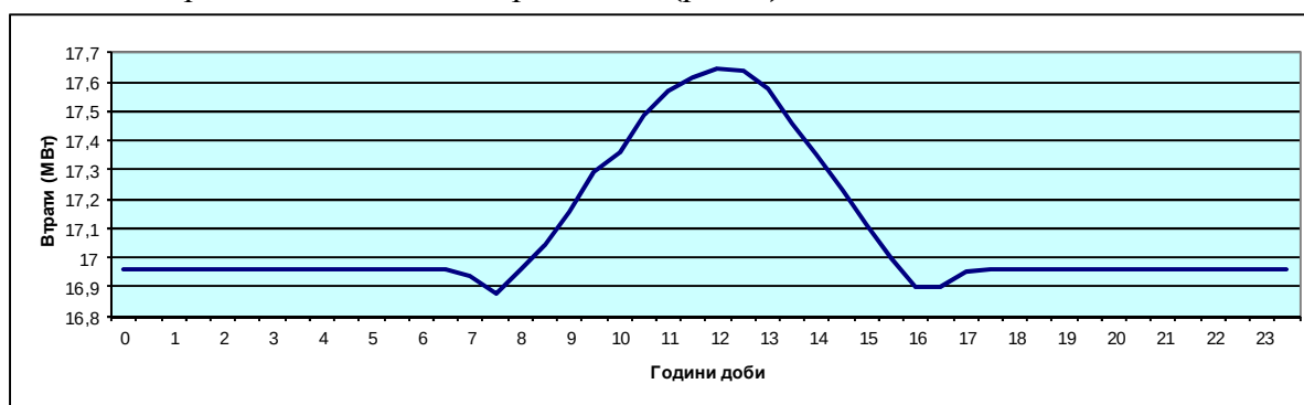
Рис. 6. Вплив генерації СЕС Арциз 28 лютого 2013 р. на втрати потужності
