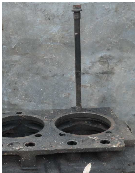
Рис. 4. Місце встановлення болта кріплення в картер двигуна
