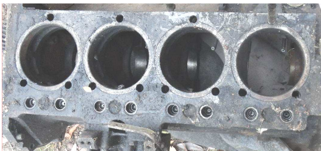
Рис. 3. Схема розташування отворів кріплення картера двигуна
