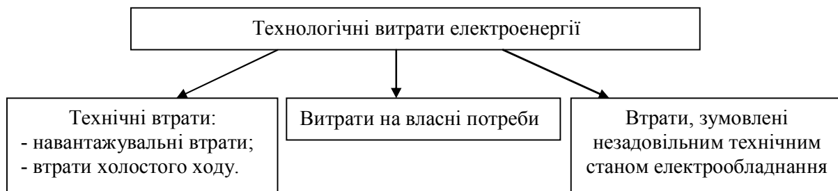
Рис. 1. Структура технологічних витрат електроенергії
