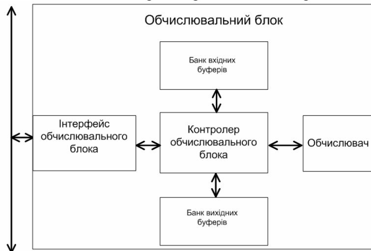
Рис. 3. Структура обчислювального блоку
