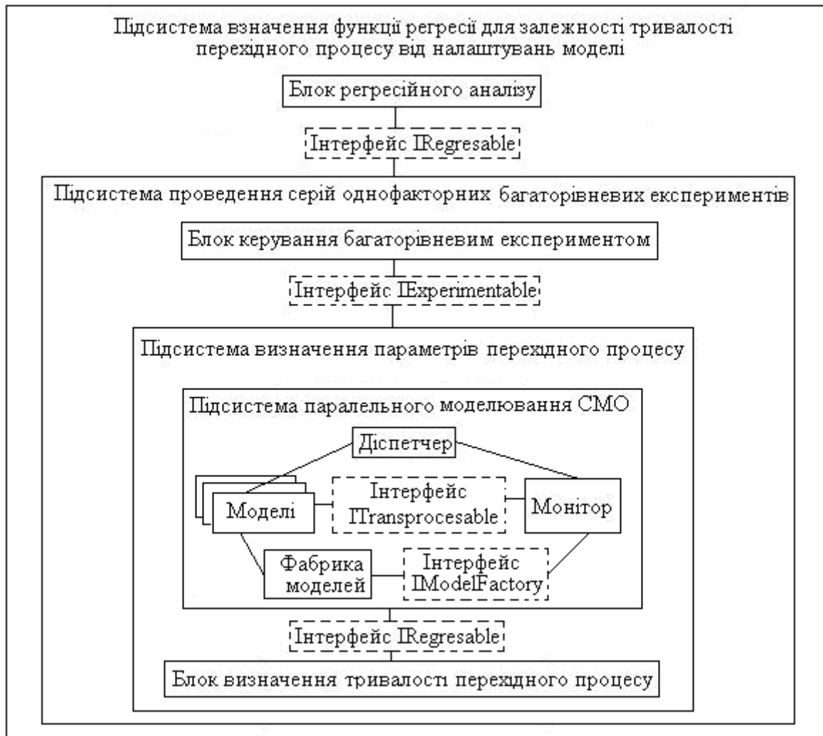
Рис. 3. Архітектура програмного комплексу для проведення експериментів
