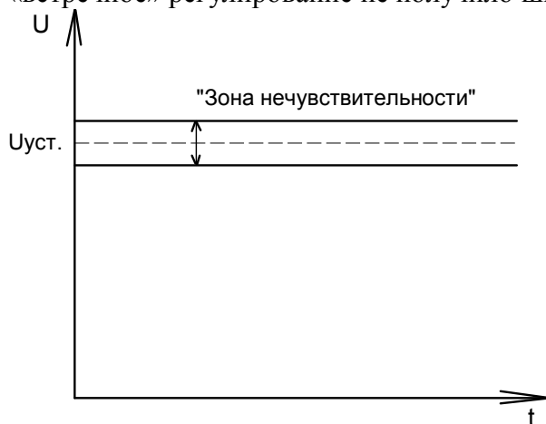
Рис. 6. Задание уставок по напряжению устройства автоматики РПН
