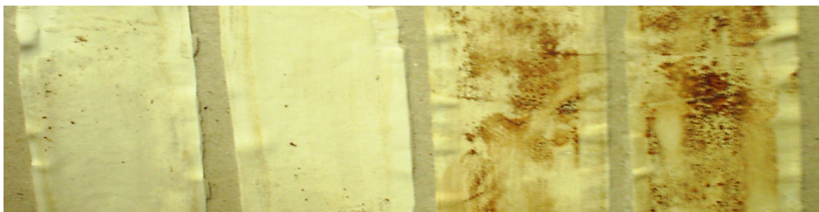
Рис. 6. Внутрішня поверхня покриття з інгібітором МГ-ЧДТУ (а) і без інгібітора (б)
