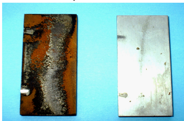
Рис. 4. Фотографії поверхні зразків Ст3 після порівняльних випробувань у воді системи опалення: a –
