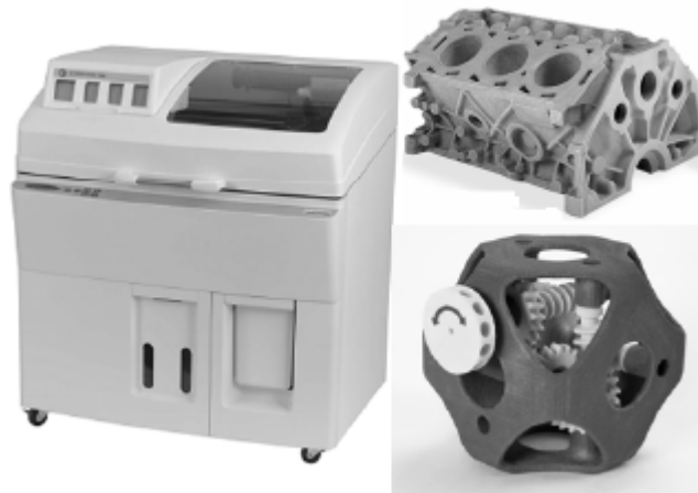
Рис.8. 3D принтер и отпечатанные часть машины и узел (сборка)
