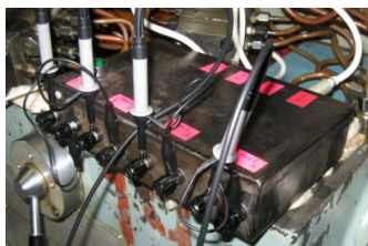
Рис. 6. Вимірювальний підсилювач ВП1 сигналу з датчиків Вт-206 (а) та його функціональна схема (б)
