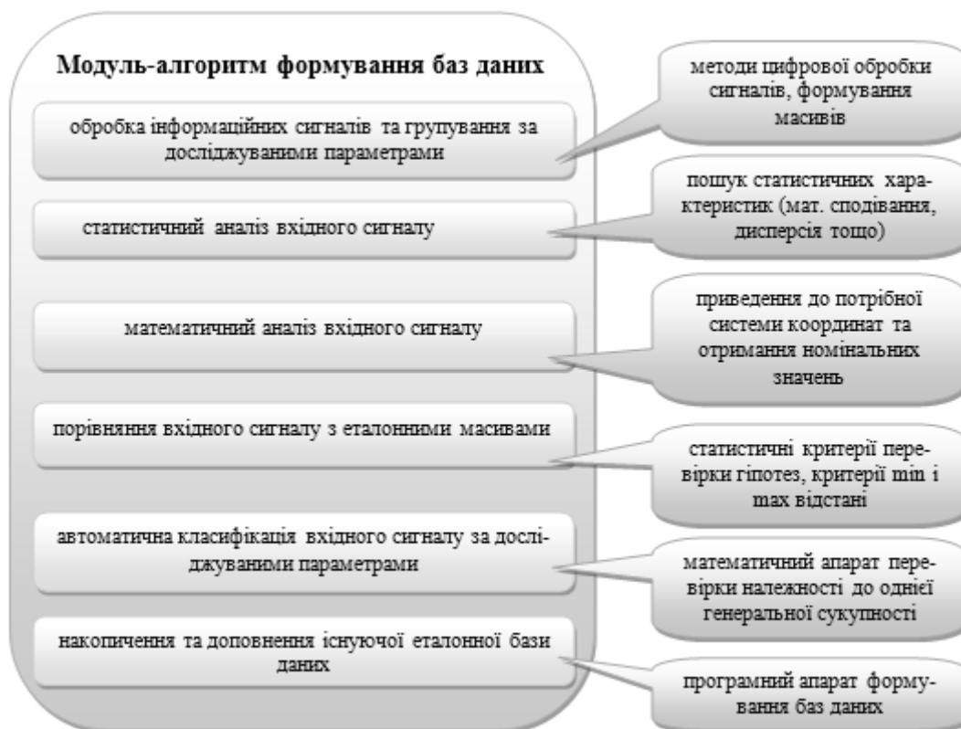
Рис. 3. Складові інформаційного циклу модуля алгоритму формування баз даних
