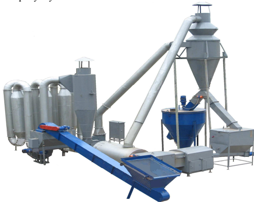
Рис. 2. Аерофонтанна сушильна установка.
